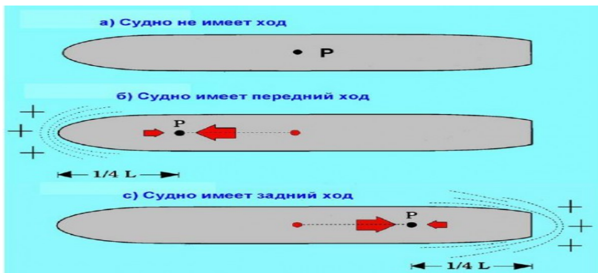
Рис. 1.1. Расположение центра вращения судна
